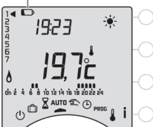
Cuando aparece el símbolo de desgaste de las pilas, dispone de alrededor de 1 mes para cambiarlas (2 pilas alcalinas 1,5 V tipo LR03 o AAA).
