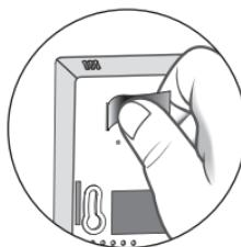
El módulo de ambiente debe instalarse a 1,5 m de altura aproximadamente, al alcance de la mano para facilitar el uso del aparato. Retire la lengüeta de protección de las pilas (sólo en la versión TYBOX 710).
